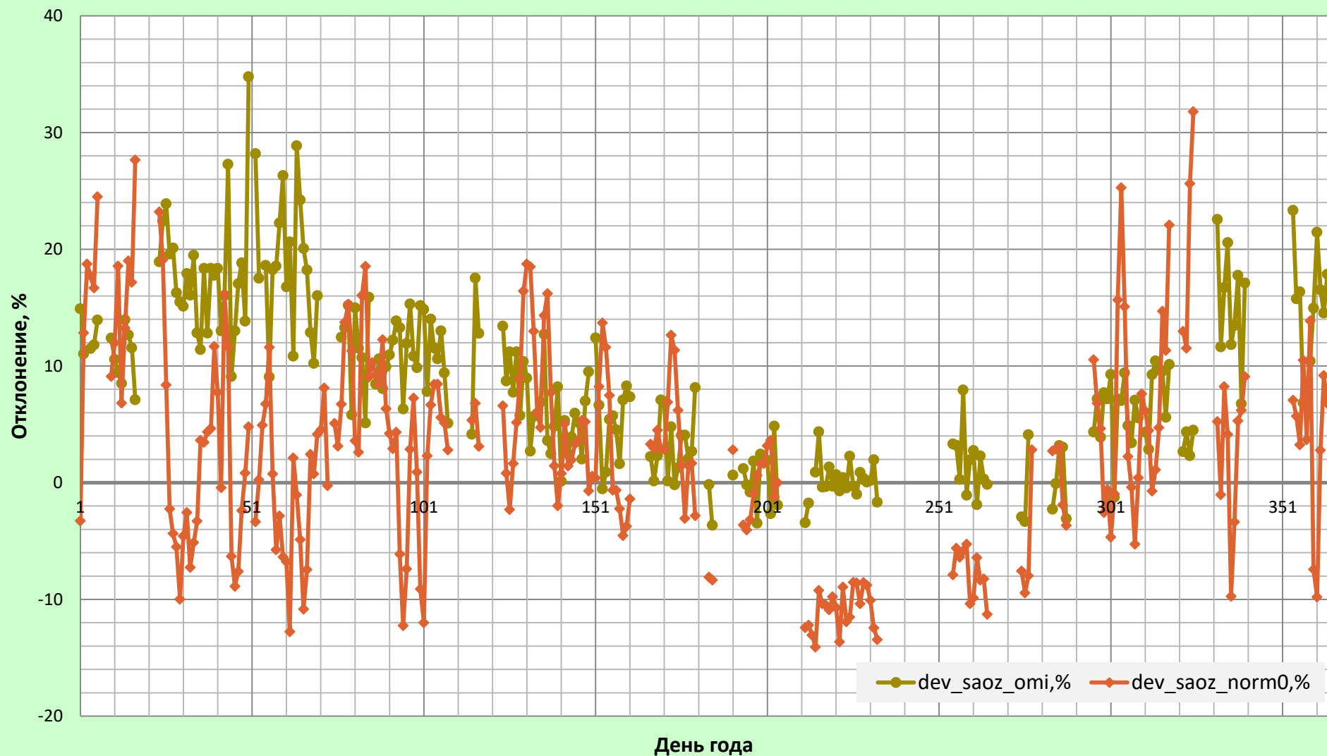
Отклонения (%) данных наземных измерений CO 2 (Mini-SAOZ) от данных спутниковых измерений CO 2 (OMI,NASA) и отклонение наземных измерений (Mini-SAOZ) от климатических норм для ст.Долгопрудный, 1 января - 30 декабря 2017 года.
